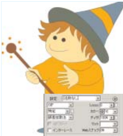
色数を16色に減色したGIFファイル。7Kバイトにまでサイズを落とすことができました。
