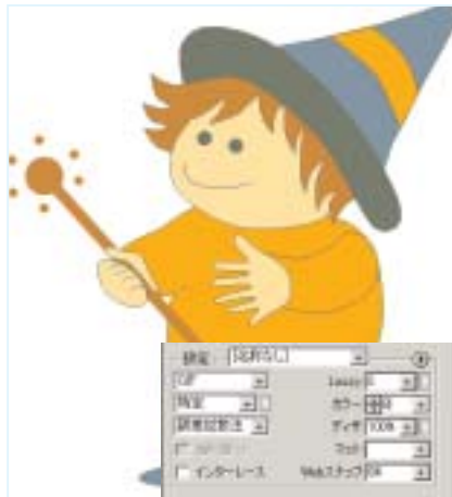
色数を8色にすると6Kバイトになったが、色がかなり変わってしまった。
